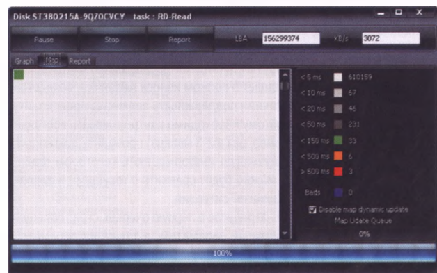
Рис. 12. Результаты сканирования диска в режиме Read с помощью HDDScan
